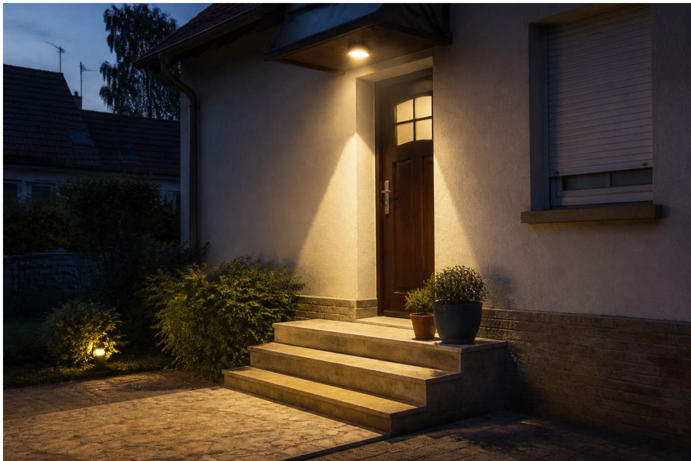
SCHÉMA DE SITUATION Un luminaire au-dessus d'un seuil doit éclairer la zone de manipulation tout en détectant l'arrivée vers la porte.
